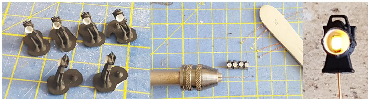
Složíme čelní partii lokomotivy. Do otvoru zalepíme konektor A delším vývodem směrem vzhůru (zelená šipka), plastová část konektoru lícuje s vrchem rámečku (červená šipka). Na konektor naletujeme zespodu vodiče, tímto konektorem jsou napájené přední (A) i zadní reflektor (B) (je-li osazen) a osvětlení kabiny (C). Některé vývody tedy zůstanou nezapojeny. Rozvrhnutí pinů je libovolné, níže je pouze návrh.
