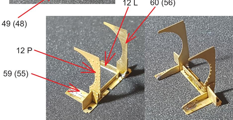
Nasadíme vždy dvojice dílů 12 P + 59(55) a 12 L + 60(56) a přiletujeme dle obrázků. Doporučuji neustále kontrolovat kolmost dílů.
