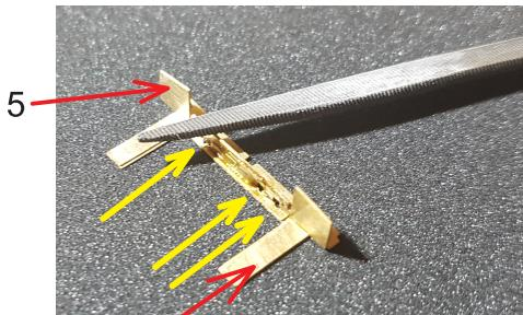
Sletujeme zadní část čelníku 49 (48) s plošinami 5. Díl 5 zapadne do drážky v dílu 49 (48), při letování jej doporučuji přitlačit pinzetou či pilníkem. Díly musí být na sebe kolmé. Pozor na orientaci výrezů v dílu 5, musí odpovídat otvorům na dílu 49 (48) (viz šipky).
