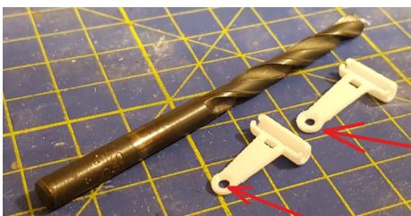
U obou běžných podvozků vytvoříme opatrně zahloubení pro hlavy šroubů. Provedeme to větším vrtákem, který v ruce otáčíme a lehce tlačíme na plast. V žádném případě nepožíváme vrtačku! Zahlobení provádíme ze spodní strany dle kresby.
