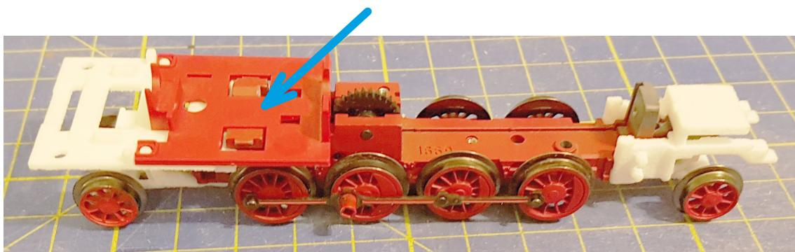
Sesadíme rám a podvozky. Matice by neměly být nikde vidět, šrouby držící podvozky nesmí odtlačovat plast od kovového rámu.
