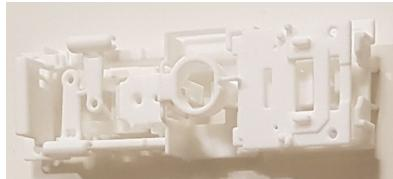
Oddělíme jednotlivé nosné díly z ABS plastu. Lze použít malé štípací kleště či skalpel. Díly od sebe neodtrhávejte, ani se je nesnažte ukrotit. Začištění provedte pilníkem či ostrým skalpelem. Vždy, než nálitky odříznete se ujistěte dle fotografií a rozstřelu dílů, že mají být opravdu odstraněny a nejsou součástí tvaru.
